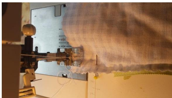
Linke und rechte Seite bis zum Stopper des Reißverschlusses zunähen
